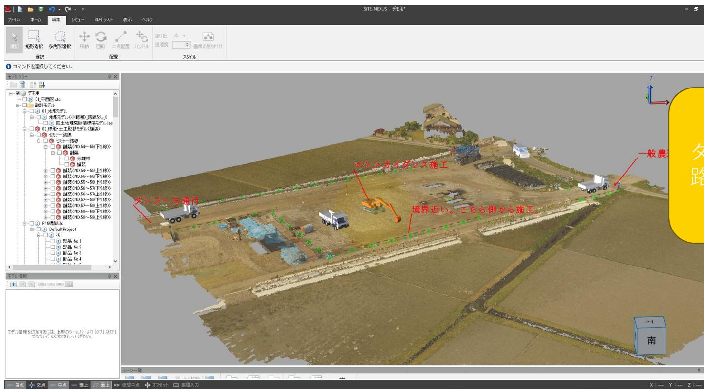
ダンプを配置し、施工敷地内の運搬経路、接続道路への安全対策等の検討。
