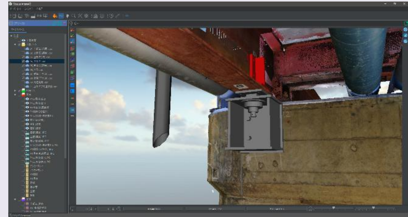
主桁との取合い確認
