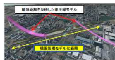
橋梁と架空線の離隔確認
