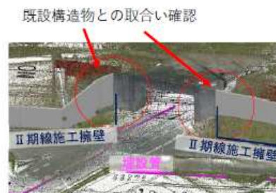
既設構造物との取合い確認
